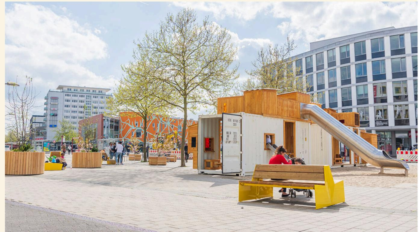
Diese Spielgeräte bestehen aus Übersee-Containern aus Stahl, die durch Einbauten aus langlebigem Robinienholz, Edelstahl, Plexiglas und Netzen sowie kreative handwerkliche Gestaltung zu Spielcontainern mit unterschiedlich großen Öffnungen in Dach und Wänden, Rutschen, An- und Aufbauten werden.
